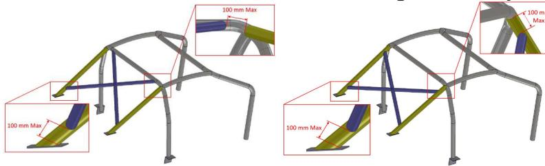
El extremo superior del tirante debe unirse al arco principal o al (backstay) a no más de 100 mm de la unión entre el arco principal y el backstay.
