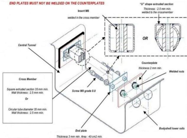
Para la base se deben utilizar rieles (del largo necesario) de caño cuadrado 35 mm x 35 mm x 2,5 mm, o tubulares de 35 mm de diámetro x 2,5mm
